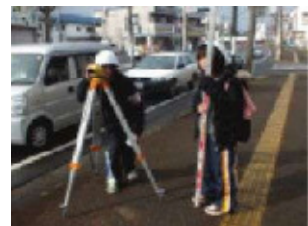
■津波痕の高さを電柱に水準器で移す。
